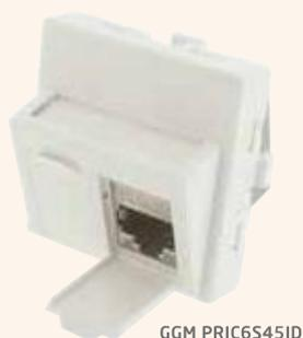
Ensemble noyau avec plastron 45x45 incliné blanc. La prise CAT6 répond aux exigences des dernières normalisations de l'EIA/TIA (ANSI/TIA-568-C.2) et de l'ISO (ISO/IEC 11801). Procédé de raccordement sans outil favorisant une mise en oeuvre rapide. Fixation en goulotte, poteaux et potelets, boîtiers 45x45.
