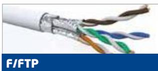
Testés à 550 MHz, et certifiés par un laboratoire indépendant (3P), les câbles GIGAMEDIA CAT6A sont conçus pour dépasser les spécifications de la classe E<sub>a</sub>, et assurer le support des applications Ethernet jusqu'au 10 Gigabit/s, aussi bien que PoE (télé-alimentation selon IEEE 802.3af/at). Son blindage général et par paire optimise les performances de Next, et vous assure une bande passante optimale.
